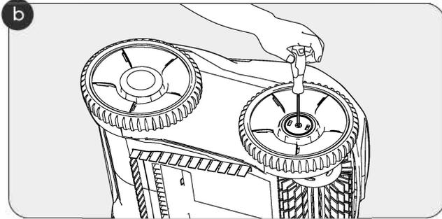
c. Entfernen Sie die Welle und die Hülsenabdeckung des Rades, um es vollständig zu demontieren.
