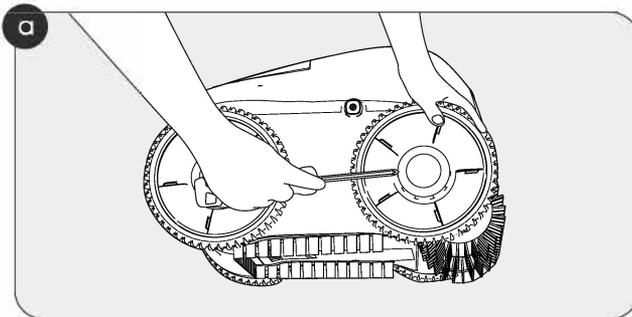
b. Entfernen Sie die Schrauben, welche das Rad befestigen.
